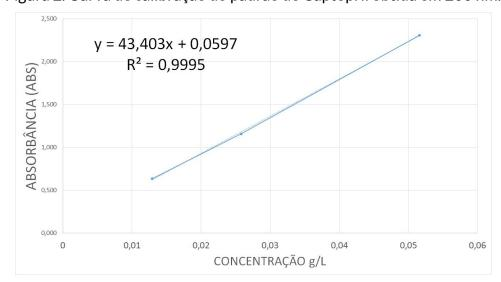
Figura 2. Curva de calibração do padrão de Captopril obtida em 200 nm.
